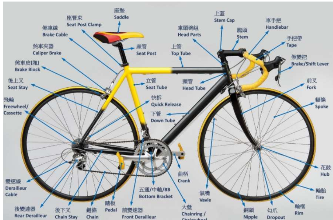
自行車各部位零件圖示
